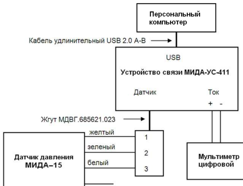
Рисунок О.1- Блок-схема подключения датчика с выходным сигналом 4-20 мА
