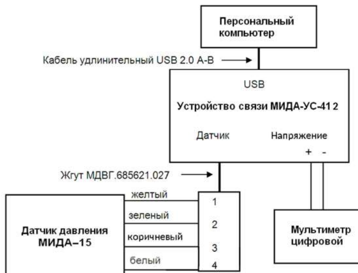
Рисунок П.1- Блок-схема подключения датчика с выходным сигналом 0,5-4,5 В
